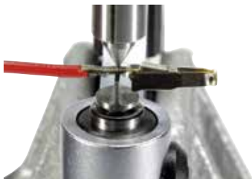
图 V-11: 测量尖头之间的压接针的细节图
