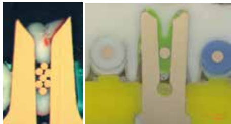
图 XI-2 和 XI-3:不良绝缘刺破
