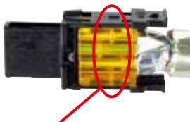
IDC - 绝缘置换插针的位置
