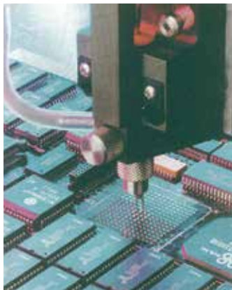
图 IX-6: 使用中的点胶机
