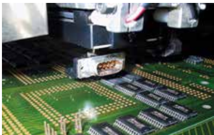
图 IX-5: 带有真空吸管和 D-Sub 的取放机
