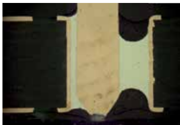
图 IX-10: 边缘填充水平-焊点
