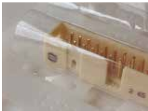
图 IX-8: 机器就绪包装中的 SEK 连接器
