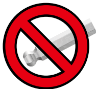
图 IV-3: 带球头的六角适配器
